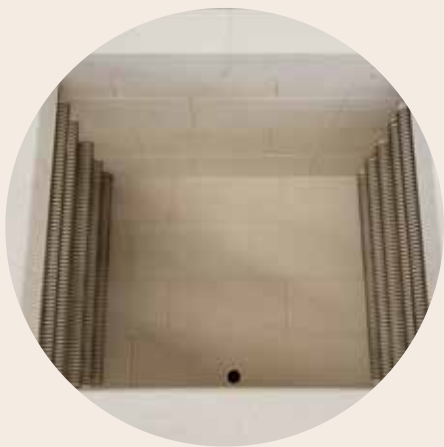
Zweiseitige Beheizung durch Heizelemente auf Trägerrohren sorgen für eine freie Wärmeabstrahlung
