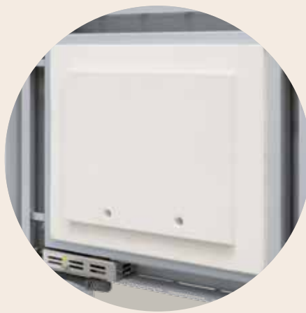
Isolierung aus Feuerleicht- und Großformatsteinen sorgen für saubere Brennergebnisse
